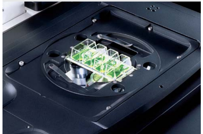
SuperZ Galvo 聚焦，用于超快速和高精度的 Z 轴光切。
