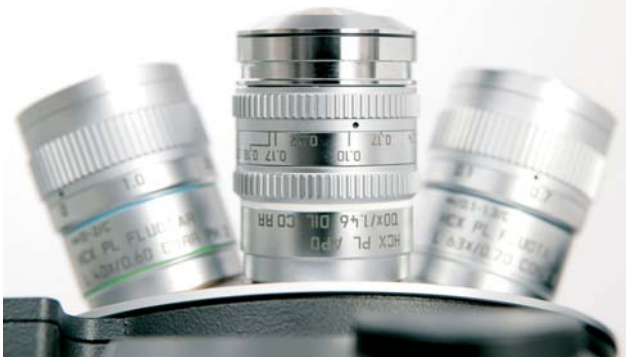
Leica HXC 平场复消色差物镜及 1.46 数字光圈，用于 TIRF 应用。
