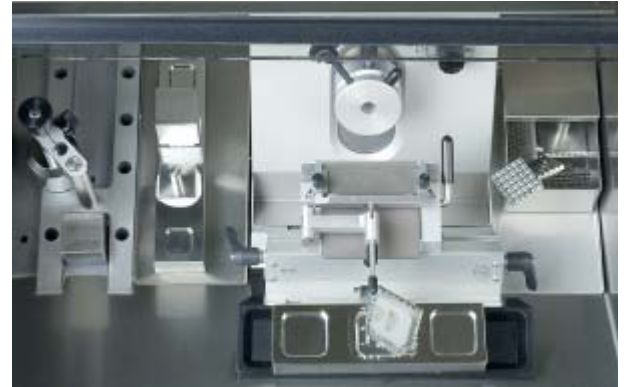
Composants de cryoinclusion de la cuve cryogénique Leica CM1850
