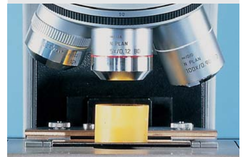
Sempre la giusta regolazione dei diaframmi con l'anello obiettivi con codifica tramite colori
