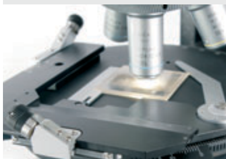
偏光回転ステージと試料ホルダー(メカニカルステージ)は、すべてのライカ偏光顕微鏡に取りつけ可能
