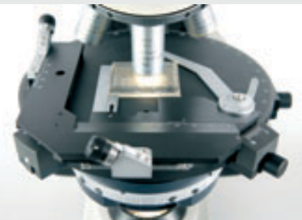
偏光回転ステージ。対角位に迅速に合わせられる45° クリックストップ付き
