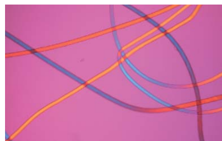
Fibre tessili, polarizzatori incrociati con lamina lambda, ingrandimento 100x.
