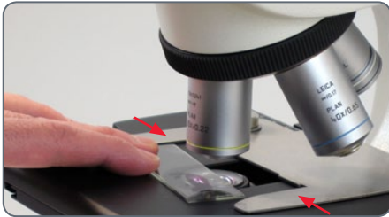
Glashållarna håller glaset på plats.
