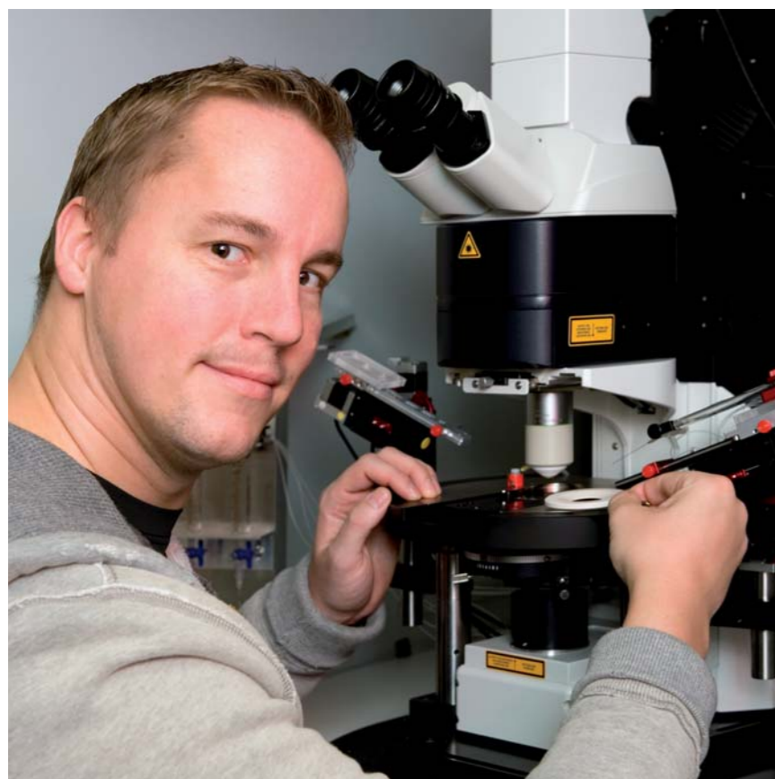
Abb. 1: Prof. Marc Spehr hat das neue Fixed-Stage-Mikroskop Leica DM6000 FS bereits vor der Markteinführung getestet: „Wir sind mit dem Gerät in punkto Optik und Stabilität sehr zufrieden. Auch der große Arbeitsabstand und der Freiraum um die Probe überzeugen uns. Die Zugänglichkeit des Probenbereichs ist für uns Neurophysiologen extrem wichtig, da wir viele Peripherie-Geräte benötigen.“
