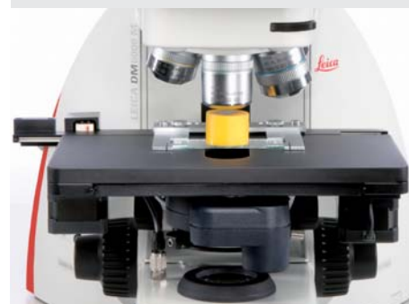
I tavolini motorizzati del Leica DM6000 M possono essere comandati tramite LAS.
