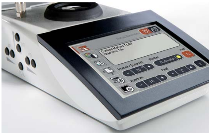
Unico nel suo genere – il display integrato nello stativo per il controllo delle funzioni del microscopio
