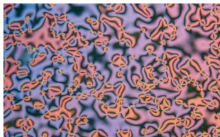
Défaut de texture d'un cristal liquide dans une cellule hybride. Polariseurs croisés, grossissement 5x.
