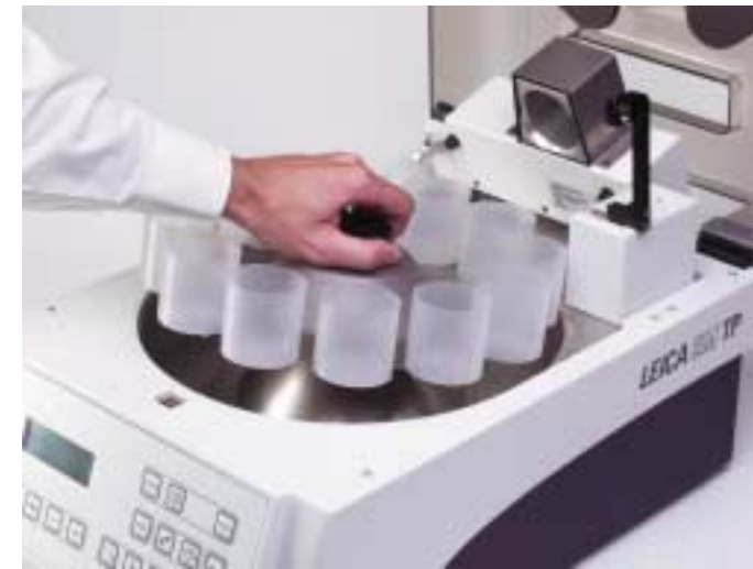
Mise en place du carrousel avec unité de chauffage/refroidissement escamotée
