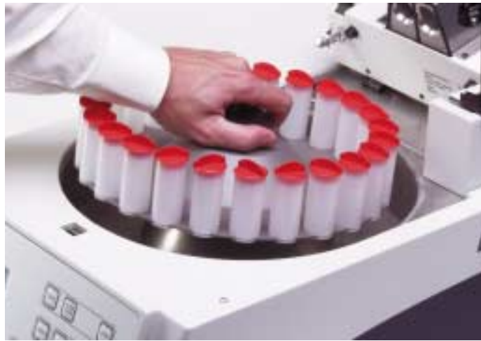
Unité de chauffage/refroidissement en position de chargement pour faciliter la mise en place du carrousel.
