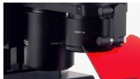
新設計対物レボルバーによる 対物レンズ切り替え
