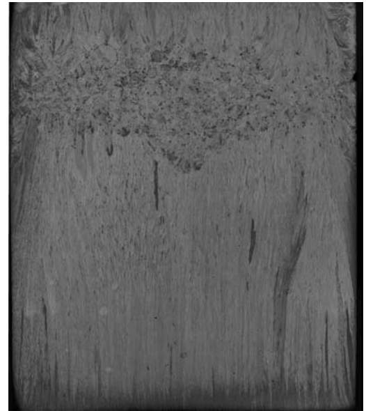
Fig. 7 : Photographie de la section longitudinale d'un alliage Sn-38M.%Pb. Un champ magnétique modulé dans le temps a été utilisé pendant la solidification.
