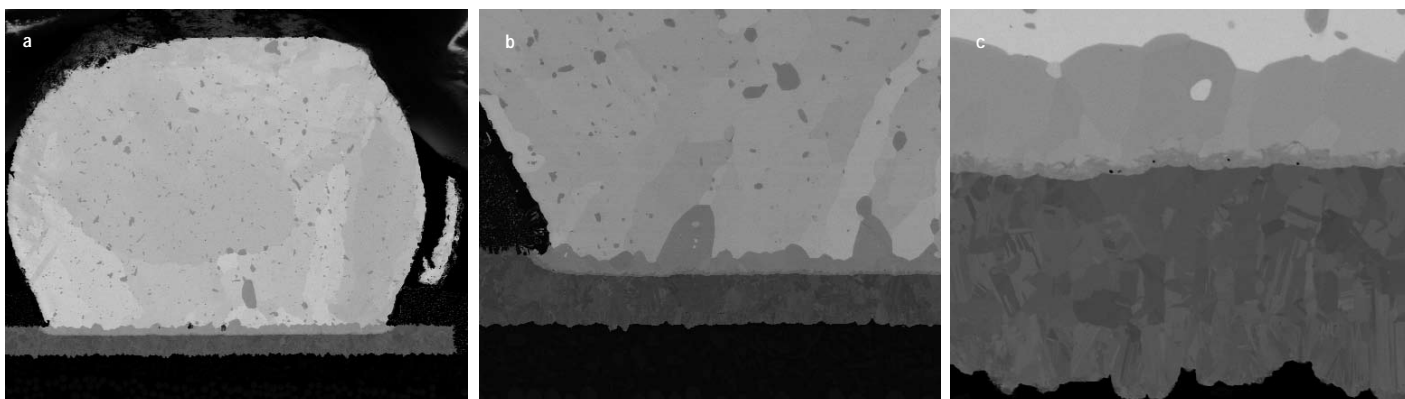
Fig. 3 : Préparé avec le Leica EM TIC020 : bille de soudure à la surface de contact Ni/Co
