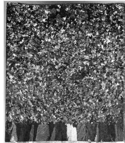
Fig. 4 : Photographie d'un alliage Al-7M.%Si solidifié de manière dirigée : la solidification dans la partie inférieure sans champ magnétique entraîne une croissance colonnaire. L'utilisation d'un champ magnétique modulé dans le temps entraîne une croissance du grain globulitique dans la partie supérieure de l'échantillon.
