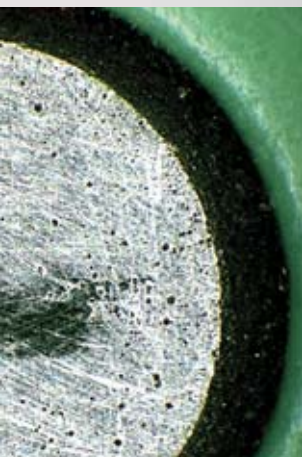
Corrosión en metal, iluminación coaxial
