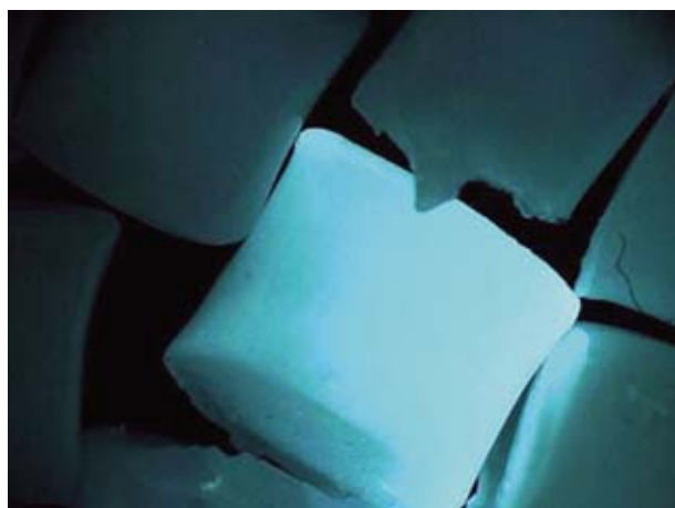
Plastica polimerizzata, esame del materiale, fluorescenza
