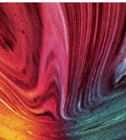
Taglio in un pezzo in plastica con polarizzatore
