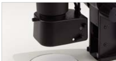
Illuminazione coassiale per le superfici piatte e ad alta riflessione come wafer e rettifiche su metallo
