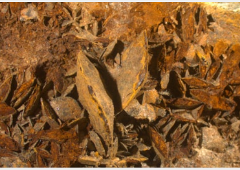
Cristalli di siderite quale riempimento di frattura nel carbonato
