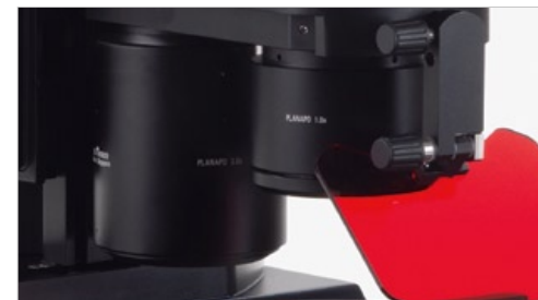
Sostituzione dell'obiettivo rapida con la nuova torretta portaobiettivi
