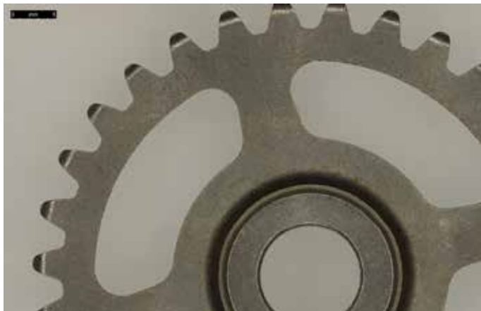
全体画像：自動車ドライブシステム/トランスミッションのスプロケット
