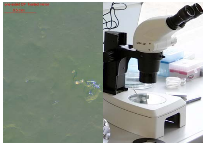
図 5：ライカ S6 と照明サブベース（右）を用いて撮影した、寒天上の線虫の画像（左）。線虫のコントラストを高めるために、サブベースの拡散反射ミラーを用いて、片側暗視野照明で撮影された画像。
