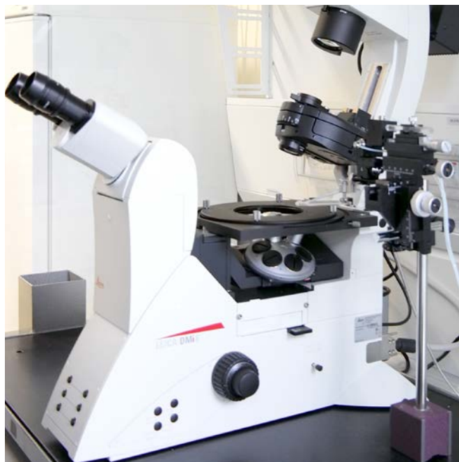
図 7：線虫の生殖巣へのマイクロインジェクションのために使用されるカスタマイズされたオイルマイクロマニピュレータを備えたライカ DMi8 倒立型複式顕微鏡。
