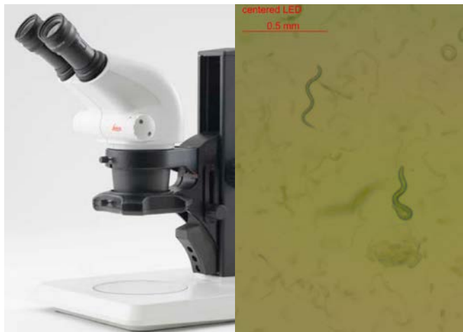
図 4：ライカ S6 と LED2500 透過光スタンド（左）を用いて撮影した、寒天上の線虫の画像（右）。画像の鮮明なコントラストにより、線虫を寒天から容易に判別することができます。
