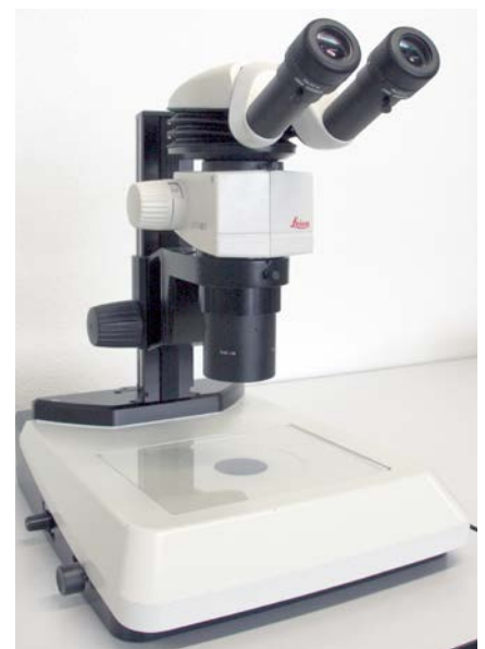
図 6：ライカ M80 と TL3000 ST 透過光スタンドベース (右) を用いて撮影した、寒天平板上の線虫の画像 (左)。暗視野により、線虫をよく観察することができます。
